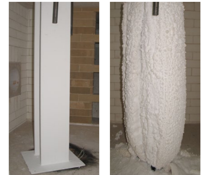
Abb. links: Beschichteter Probekörper vor dem Brand Abb. rechts: Aufgeschäumter Probekörper nach dem Brand
