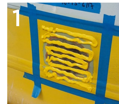
1 Aufbringen des Beschichtungsstoffs
